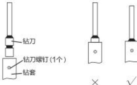
安装钻刀：将钻刀装入钻套的钻刀口，将钻刀装至底部后，使用内六角扳手锁紧钻刀螺钉后，按[复位]键即可。
